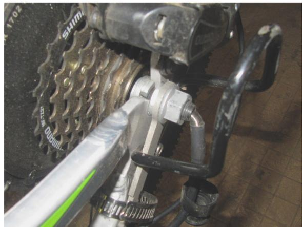
Serrez progressivement les écrous de roue, fermement mais sans abus. Le couple de serrage doit se situer autour de 25 Nm (soit 2.5kg au bout d'1 mètre, ou 12,5 kg au bout de 20 cm). Serrez bien des deux côtés !
