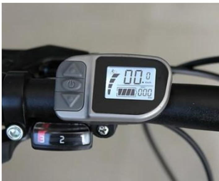
La console peut être installée sans aucun démontage des poignées/leviers de freins.
